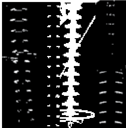
Slika 3: Binarne maske izolatora nakon invertovanja vrednosti piksela i obrade CLAHE algoritmom
